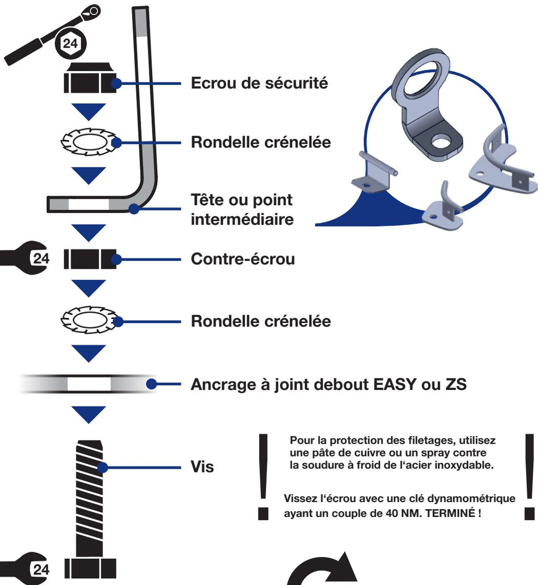
! Pour la protection des filetages, utilisez une pâte de cuivre ou un spray contre la soudure à froid de l'acier inoxydable. !
