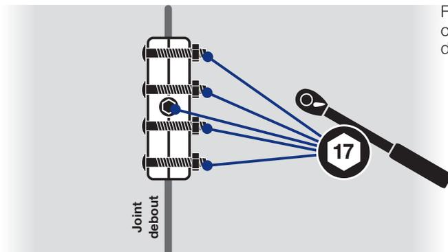
Fixation uniquement aux points où la transmission de la force dans la structure est donnée.
